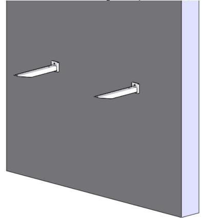
Anschließend können die Befestigungsstützen des Gerätes an den Wandbefestigungen fixiert werden.
