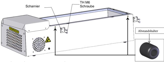
Befestigen Sie die Scharniere mit TH M6-Schrauben und verzinkten L6N-Unterlegscheiben am Gerät.
