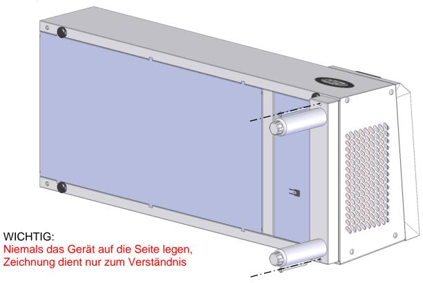
Durch die kürzere Blechfalten des rechten Montagekits können wir dies Falte unter dem Gerät installieren, ohne durch die untere Falte der rechten Seite behindert zu werden
