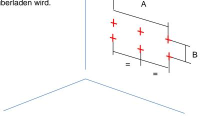
Lokalisieren Sie an der Wand 4 Befestigungspositionen unter Berücksichtigung der wagerechten Position und der Höhe des Geräts (Abstand B zwischen den beiden Befestigungen einer Wand = 131 mm). Für die Versionen PC 189 und PC 221 gibt es 3 Halterungen, also 6 Befestigungspositionen (3. Halterung in der Mitte) Seite A:
