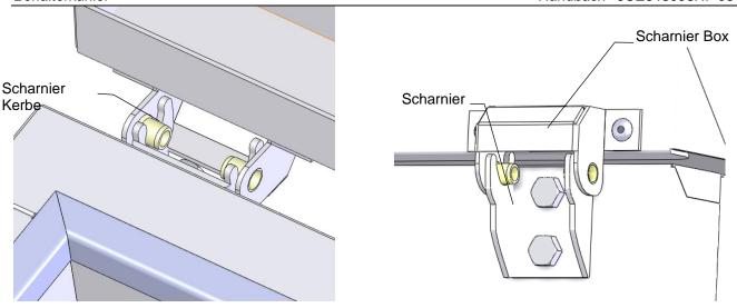
Klicken Sie einfach auf die Abdeckung des Geräts, indem Sie die Drehzapfen (an den Scharnierkästen der Haube angebracht) in die Scharnierkerben einsetzen.
